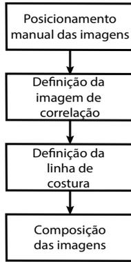
Figura 3. Pipeline com a divisão dos passos para a execução do algoritmo.
