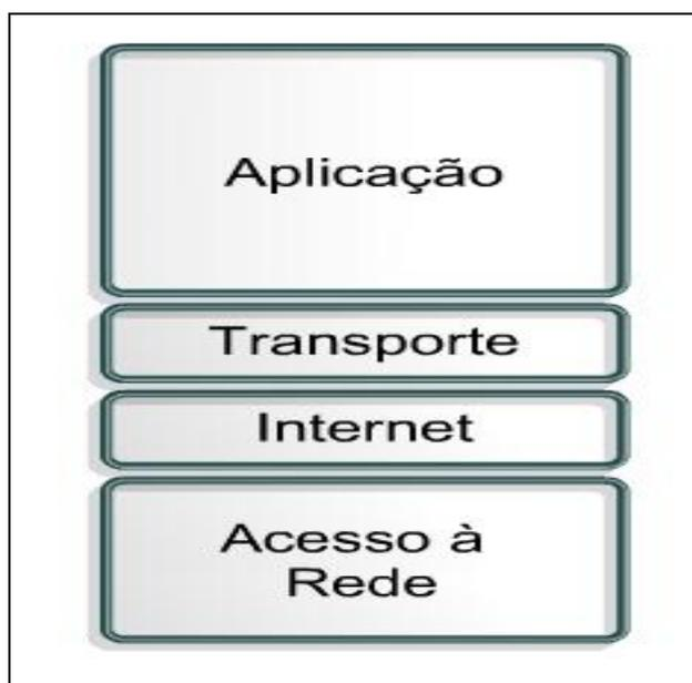
**Figura 1 - Pilha TCP / IP**
